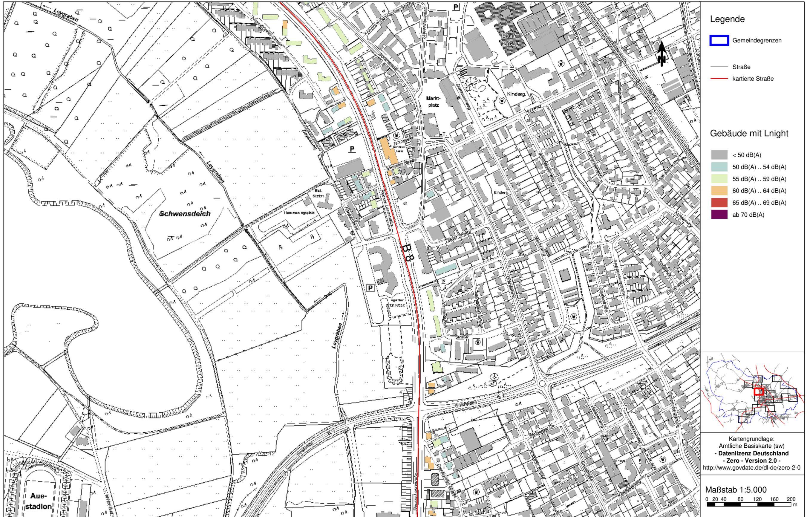
Anlage 6.8: Gebäude mit Kennzeichnung des maximalen Lnight aus Straßenverkehrslärm
