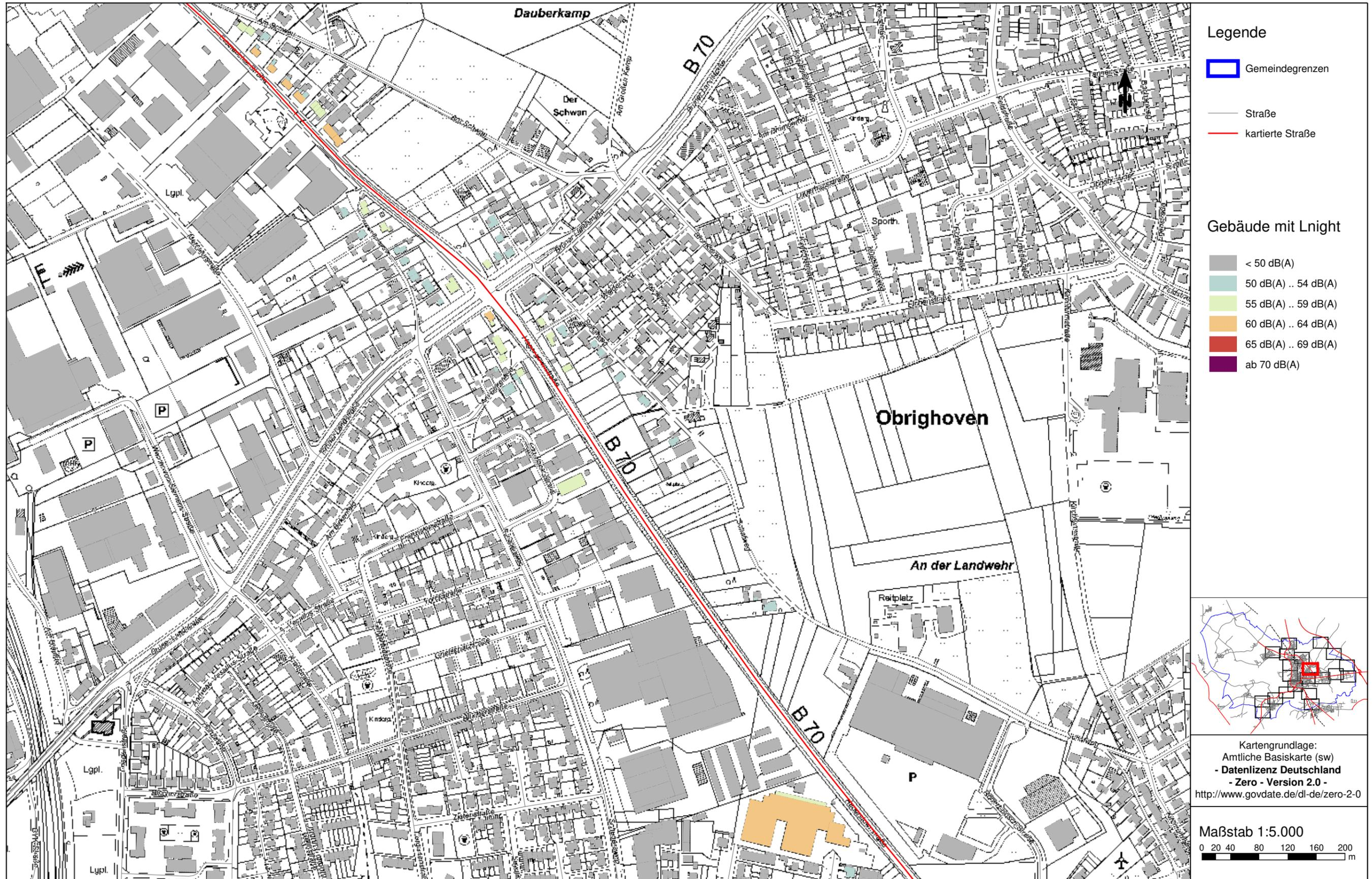
Anlage 6.13: Gebäude mit Kennzeichnung des maximalen Lnight aus Straßenverkehrslärm
